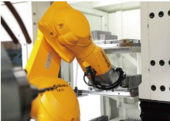
Stäubli TX2-60 Robot Loader (TA-5)
